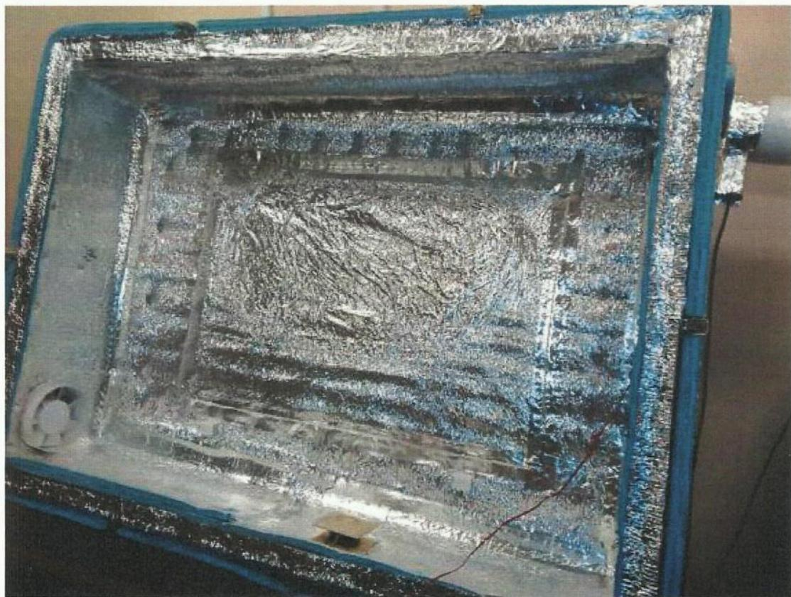
Рис. 9 — Теплоизолированный бокс для проведения калориметрических испытаний и расположение испытуемого электронагревателя в теплоизолированном боксе.
