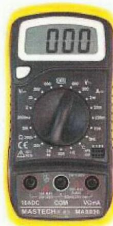
Рис. 1 - Мультиметр MAS838
