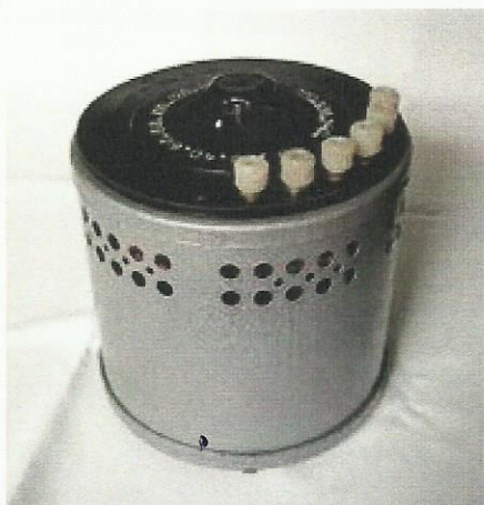
Рис.7 - лабораторный ЛАТР М1
